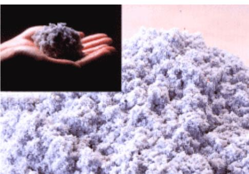
100%リサイクル古紙を原料とする【住宅用断熱材】地球に優しいエコマーク商品として、国際的に認定されている。優れた「断熱性能」以外に防音・防虫・調湿効果に優れ、壁内結露防止にも役立っていることから、TVや雑誌等でもたびたび取り上げられ、近年脚光を浴びている。
