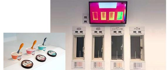
窓のフレーム素材やガラスの種類によって変わる断熱性を体感できるコーナー。サーモグラフで確認し、直接手で触れることで違いを体感できます。
